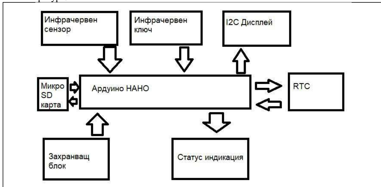
Фиг. 1 Блокова схема на устройството за безконтактно измерване на температура
