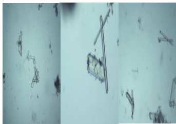
Фиг. 34 Микроскопски снимки на полученият струвит в БЕК
