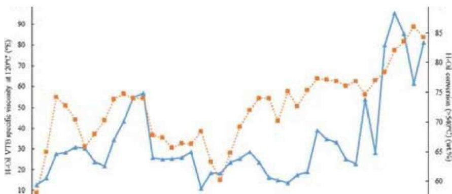
Фиг.13 Вариация на специфичния вискозитет на H-Oil VTB и конверсията от пускане на хидрокрекинг на гудрон H-Oil в рафинерията на ЛНБ
