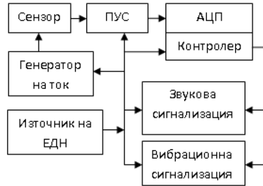
Фиг.2. Блокова схема на термопредупредително устройство
