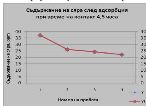
Фиг. 1. Съдържание на сяра в продукта след адсорбция при време на контакт – 4.5 часа
