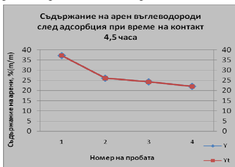
Фиг. 3. Съдържание на аренови въглеводороди след адсорбционно почистване при време на контакт – 4.5 часа
