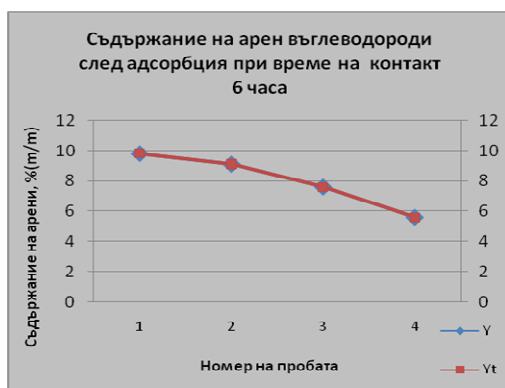
Фиг. 4. Съдържание на аренови въглеводороди след адсорбционно почистване при време на контакт – 6.0 часа
