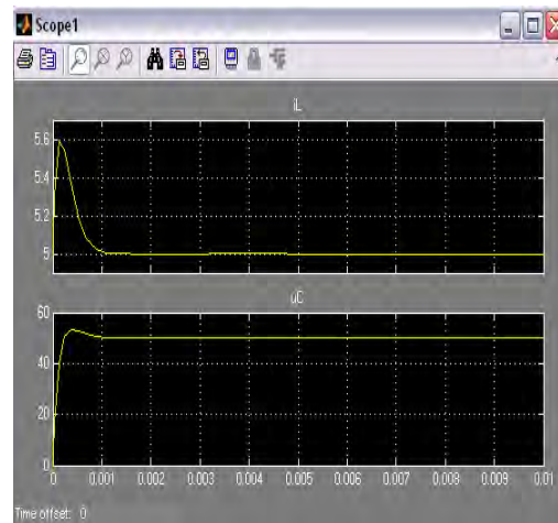
Фиг. 5. Осцилограми на тока i_L и напрежението u_C при R_1 = R_2 = 10 \Omega .
