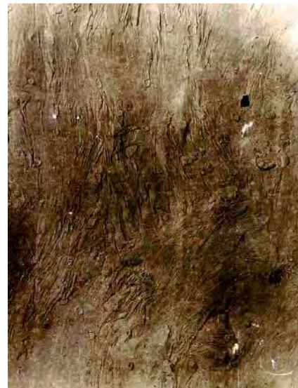
Фиг. 6. ТЕМ микрофотография на смес от 80% захароза и 20% полиетилен оксид, 5000 × .
