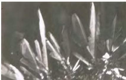
Фиг. 3. Поляризационна микрофотография (50 × ), илюстрираща различна морфология на кристализираща захароза след ликвация при нагряване на смеси с полиетиленоксид.
