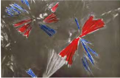
Фиг. 1. Поляризационна микрофотография (50 × ) на полиетиленоксид, илюстрираща \alpha(-) сферолитна картина.
