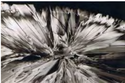
Фиг. 2. Поляризационна микрофотография (50 × ) на захароза, илюстрираща \alpha(+) сферолитна картина.
