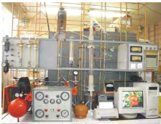
Фиг. 1. Лабораторна инсталация за пиролиз на оризови люспи в реактор “кипящ” слой.
