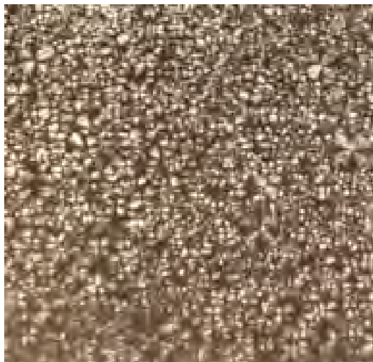
Фиг. 1. СЕМ-фотография на сферолити от кристализирал 7200 сек при 473 К ПКЛ изотропна фолия 1000 × . Сферолити ≈ 0,1 мм
